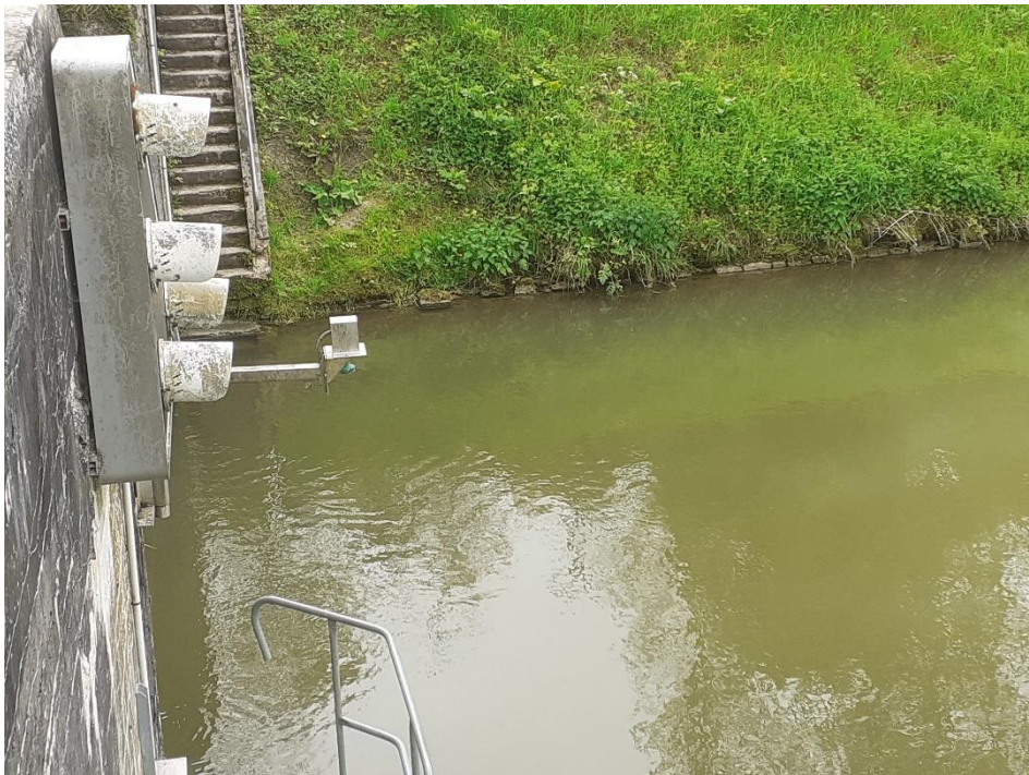
Sonde du bief à l'aval de l'écluse de Givry
