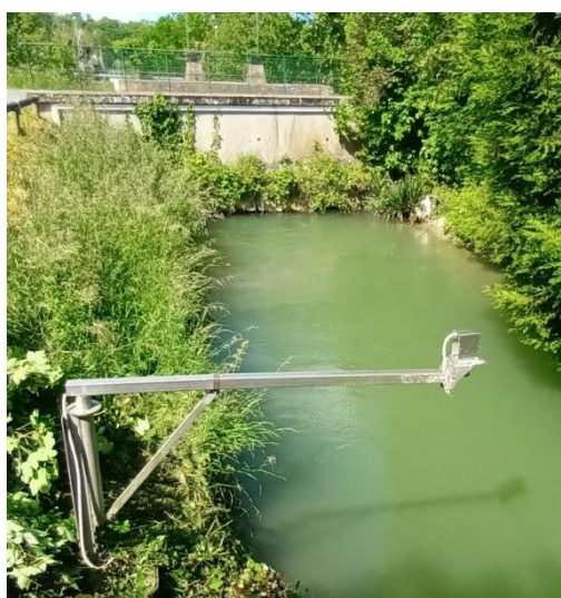
Sonde aval (dans la rigole)
